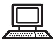
Dieses Symbol bedeutet, dass ein GLT-System an die Anlage angeschlossen ist. In diesem Fall wird die Programmierung durch das GLT-System verwaltet.
